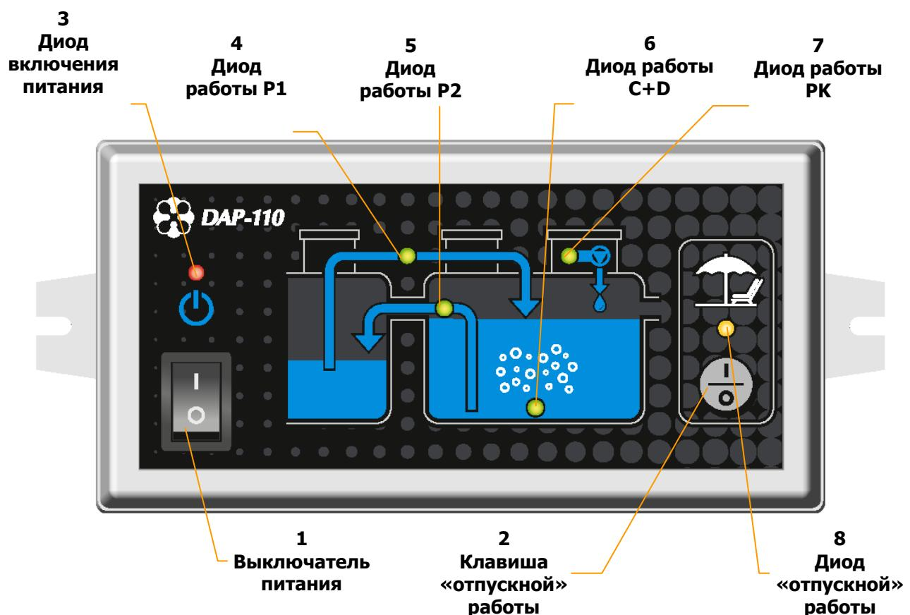
На панели управления оборудования расположены светодиоды , сигнализирующие последние включения оборудования (4,5,6,7), светодиоды режима работы системы (3,8), функциональная клавиша (2) , а также выключатель питания (1).
