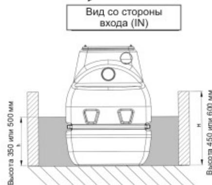
Жиросепаратор SL-SG (предназначен для придомовых локальных очистных сооружений)
